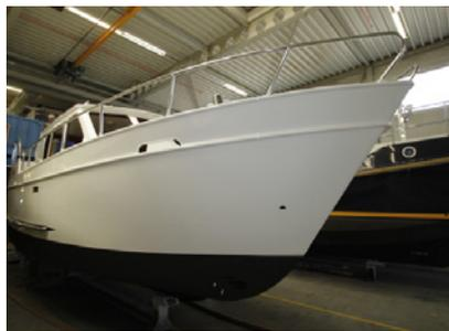
*Eine Linssen 32 SL aus dem Jahr 1986. Auftragen eines neuen Lacks und komplette Innenraumüberarbeitung.*
