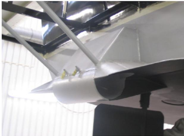
*Professioneller (nachträglicher) Einbau einer Heckschraube, integriert in den Kasko.*
